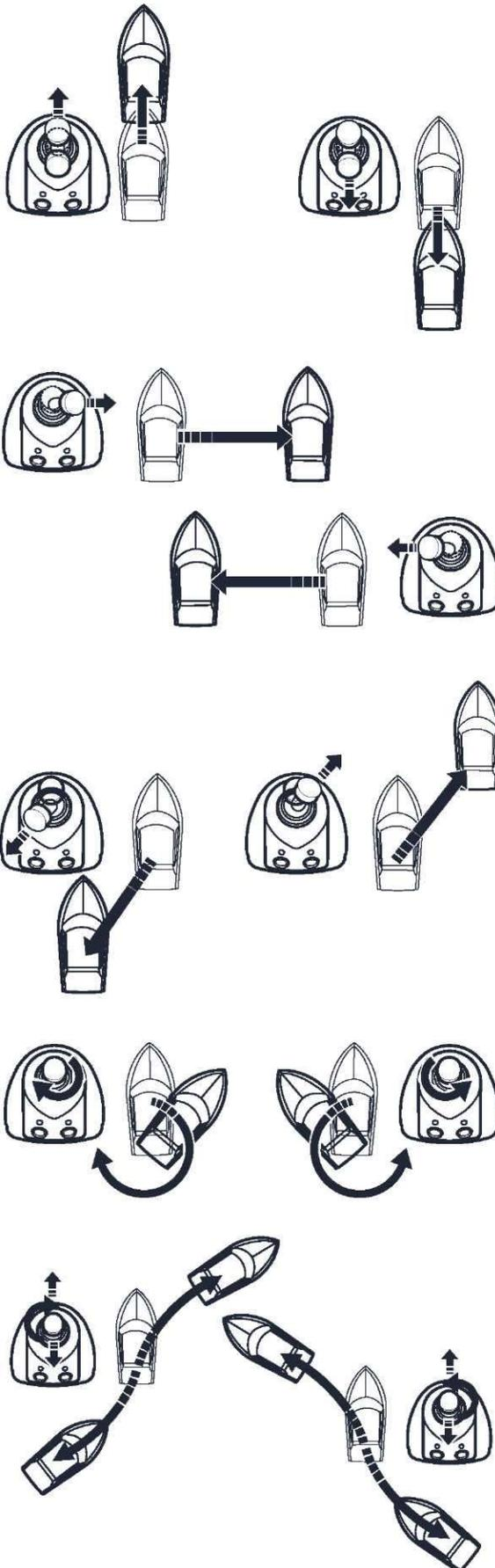
Der Joystick ist ein intuitives Einhebel-Bedienelement, über das der Fahrer das Boot manövrieren kann. Entsprechende Funktionen hängen vom jeweiligen Modell ab. Beziehen Sie sich auf relevante OEM-Unterlagen, bevor Sie eine solche Ausrüstung verwenden.
